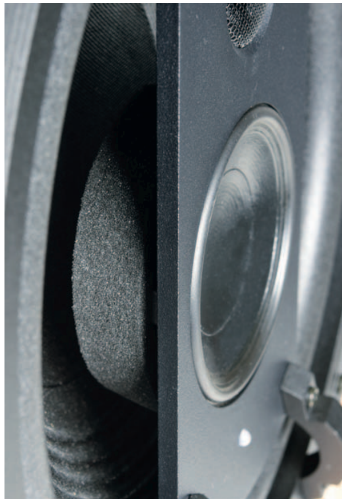
Vor dem Bass befindet sich die Brücke der Mittel-Hochton-Sektion. Geithains Geschick spiegelt sich im gehäuselosen Mitteltöner, der durch einen halboffenen Schaumstoffring bedämpft wird.
