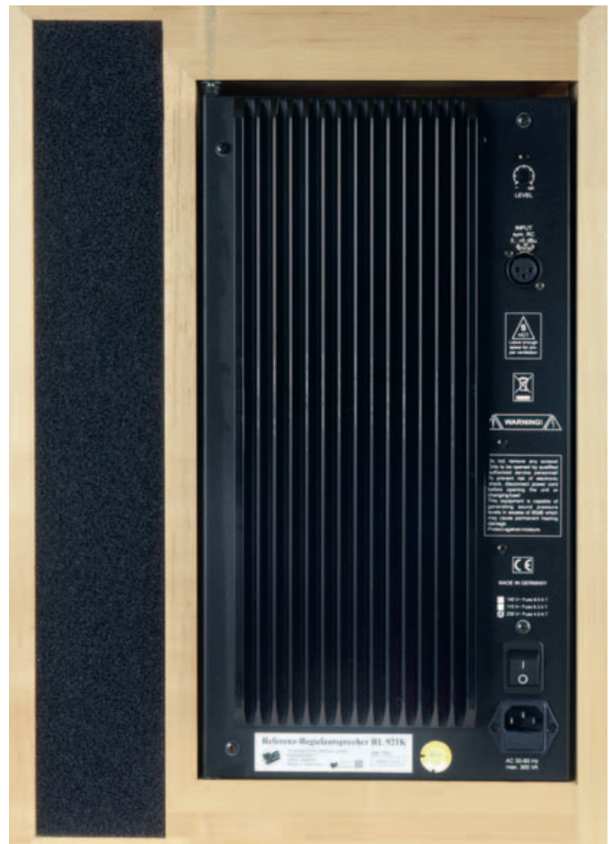
Das rückseitige Modul sitzt neben den akustischen Filterelementen für den Bass (siehe unten). Die drei Endstufen sind in Class-A/B aufgebaut und bieten „analogen“ Klang statt unendlich Leistung.
